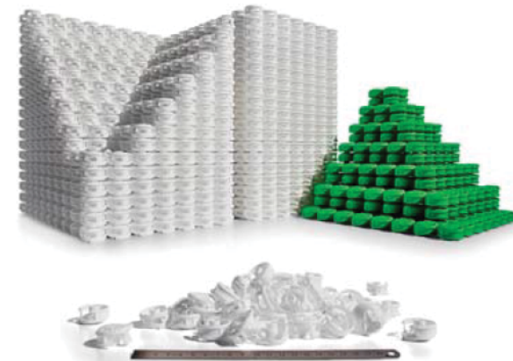
Beeindruckende Dimensionen: Die Laser-Sinter-Anlage EOS P500 fertigte beim Dornbirner Unternehmen Izu1 in knapp 16 h 2 400 Nähmaschinen-Spulenkapseln.
