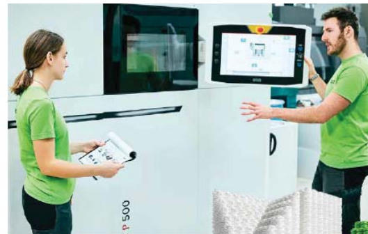
Izu1 testet seit einem Jahr die neue Kunststoff-Laser-Sinter-Anlage. Beeindruckend: Die Anlage EOS fertigte in knapp 16 Stunden 2.400 Nähmaschinen-Spulenkapseln.
