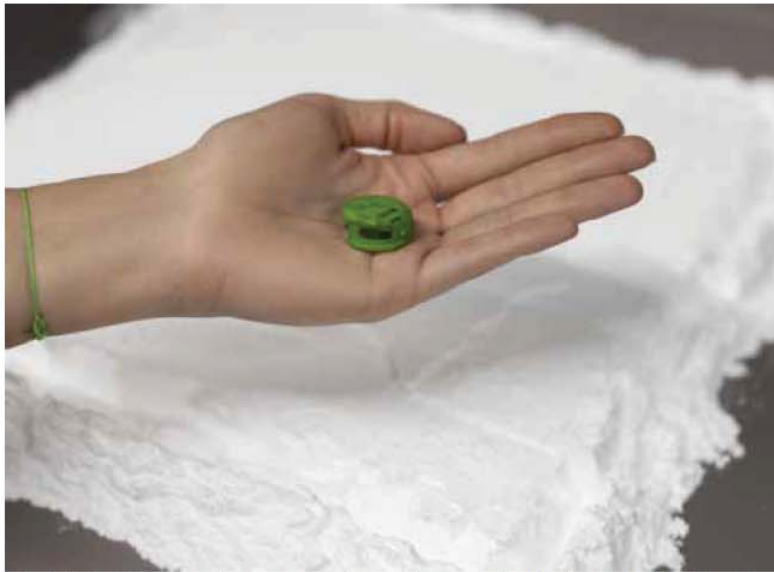
Mittels SLS-FDR lassen sich Geometrien bis auf Fingernagelgröße detailgenau und stabil im 3D-Druck herstellen.
