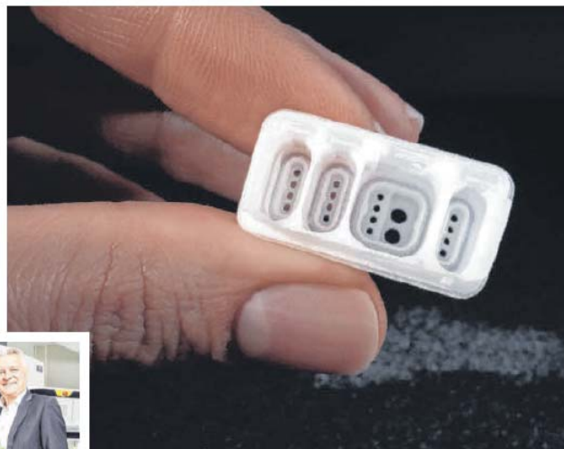
Der miniaturisierte Automobil-Stecker zeigt die hohe Detailgenauigkeit, die mit der neuen 3D-Drucktechnologie möglich ist. FA/DT
